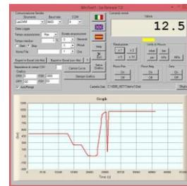
**Quick Analyzer Light:** Software professionale che si interfaccia direttamente al BTR2, supporta l'operatore nelle diverse funzioni di test, analisi, monitoraggio nel tempo, archiviazione dati, gestione diretta del **DATA LOGGER**, trasferimento delle misure su Microsoft Excel.
