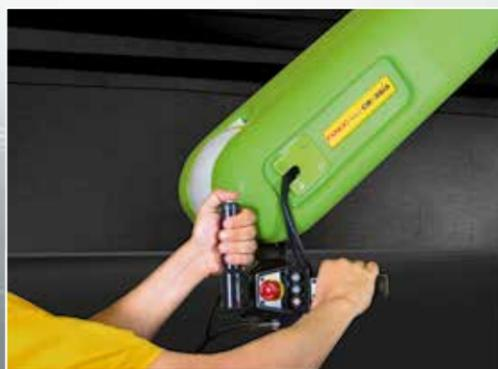
Il modello più grande CR-35 può ricevere istruzioni tramite un pulsante di arresto di emergenza e un interruttore di attivazione a tre posizioni conforme agli standard ISO 10218 e ISO/TS 15066.
