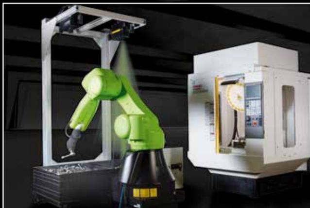
Secondo le necessità d'impiego, la serie CR può essere dotata di un sensore di visione o di un componente 3D Area Sensor FANUC.
